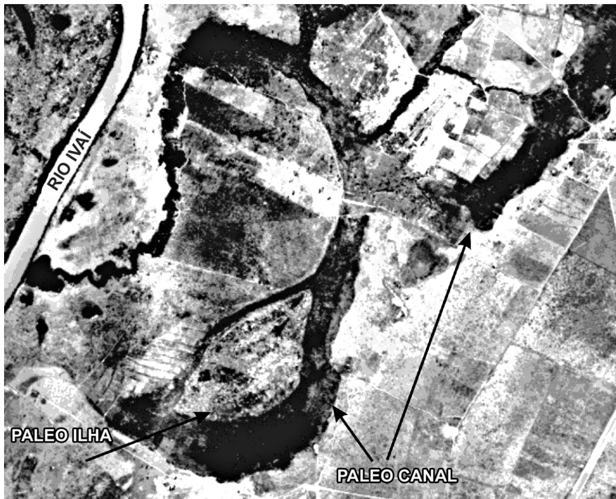
Figura 7 - Fotografia aérea da planície do rio Ivaí no município de Nordestina-PR, mostra a ocorrência de paleocanais com cerca de 400m de largura e de uma paleoilha. Note as espiras de meandro preservadas na superfície da paleoilha. Uma sondagem a vibração no paleocanal da parte inferior da fotografia, revelou um pacote de argila maciça (fácies Fm) com 11m de espessura. Escala aproximada: 1:30.000
