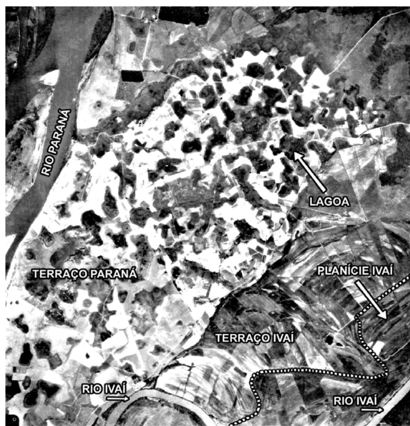
Figura 4 - Fotografia aérea mostrando o contato bem marcado entre as unidades Terraço Paraná e Terraço Ivaí. Observar no lado esquerdo da fotografia a ocorrência das lagoas que são características da primeira unidade. No Terraço Ivaí (lado direito da fotografia) tem a ocorrência de espiras de meandro orientadas grosseiramente perpendicular ao rio Ivaí. No canto inferior direito da fotografia, ladeando o canal do rio Ivaí, ocorre a unidade Planície Ivaí. Note que as espiras de meandro, nessa unidade, truncam as do Terraço Ivaí
