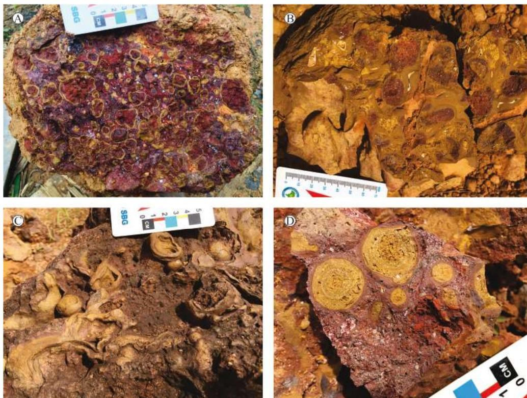
Figura 4 - A e B) Nódulos hematíticos de cor vermelha escura com córtex goethítico amarelado, C) Nódulos amarelados (goethita) evidenciados na parte externa do bloco de crosta laterítica. D) Nódulos goethíticos amarelados, (porção interna) circundados por matriz hematítica avermelhada e porções com caulinita e quartzo.
