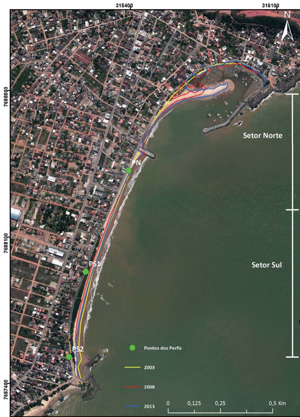
Figura 6 - Configuração em planta no período pós-intervenção (2003, 2008 e 2013). Setor norte, sob influência direta da adaptação morfológica da praia de enseada e Setor Sul, rumo ao promontório sul. Localização dos perfis transversais Norte (PN), Sul 1 (PS1) e Sul 2 (PS2).
