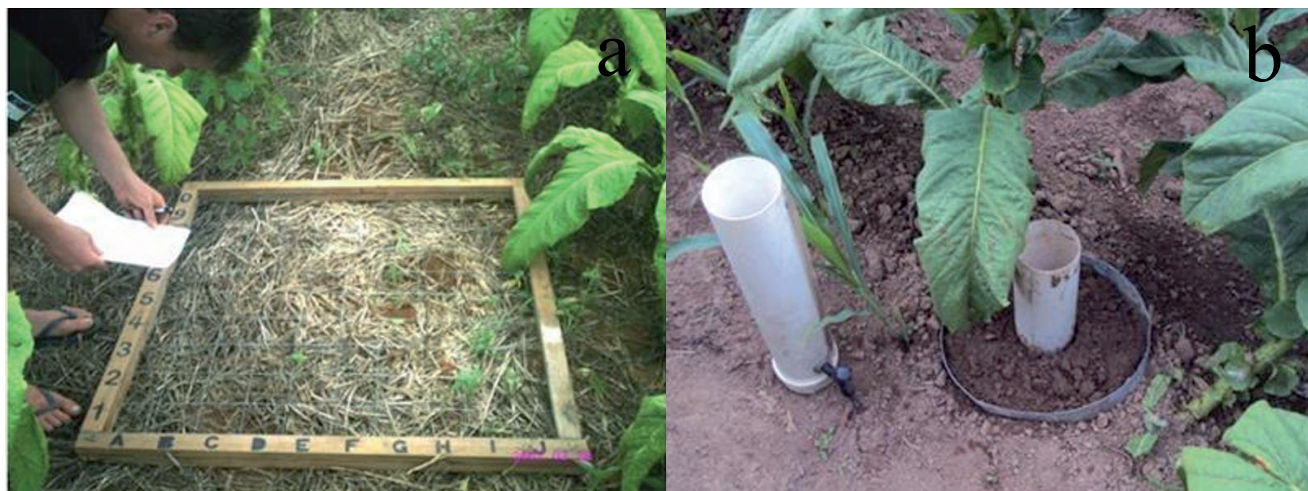
Figura 3 - a) amostrador de exposição do solo no plantio direto em área de cultivo do tabaco. b) infiltrômetro instalado no camalhão em cultivo do tabaco. Foto Antoneli, V. (2011).
