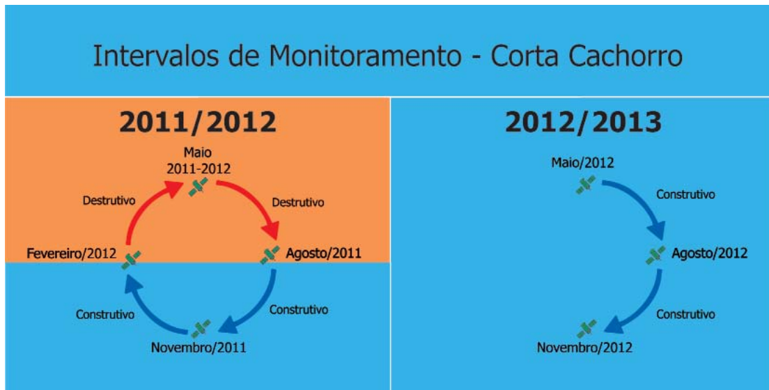
Figura 13 - Intervalos de monitoramento e padrão de dinâmica sedimentar da área de estudo, de acordo com informações obtidas em Souto (2009) e Nascimento (2009) e aplicado por Santos (2011). Intervalo construtivo de fevereiro a agosto e intervalo destrutivo de Agosto a novembro. Os intervalos construtivos são característicos de ventos (SE) e ondas (NE) de baixa energia e os destrutivos de ventos (ENE) e ondas (NE) de alta energia. Fonte: Adaptado de Santos; Amaro (2012).
