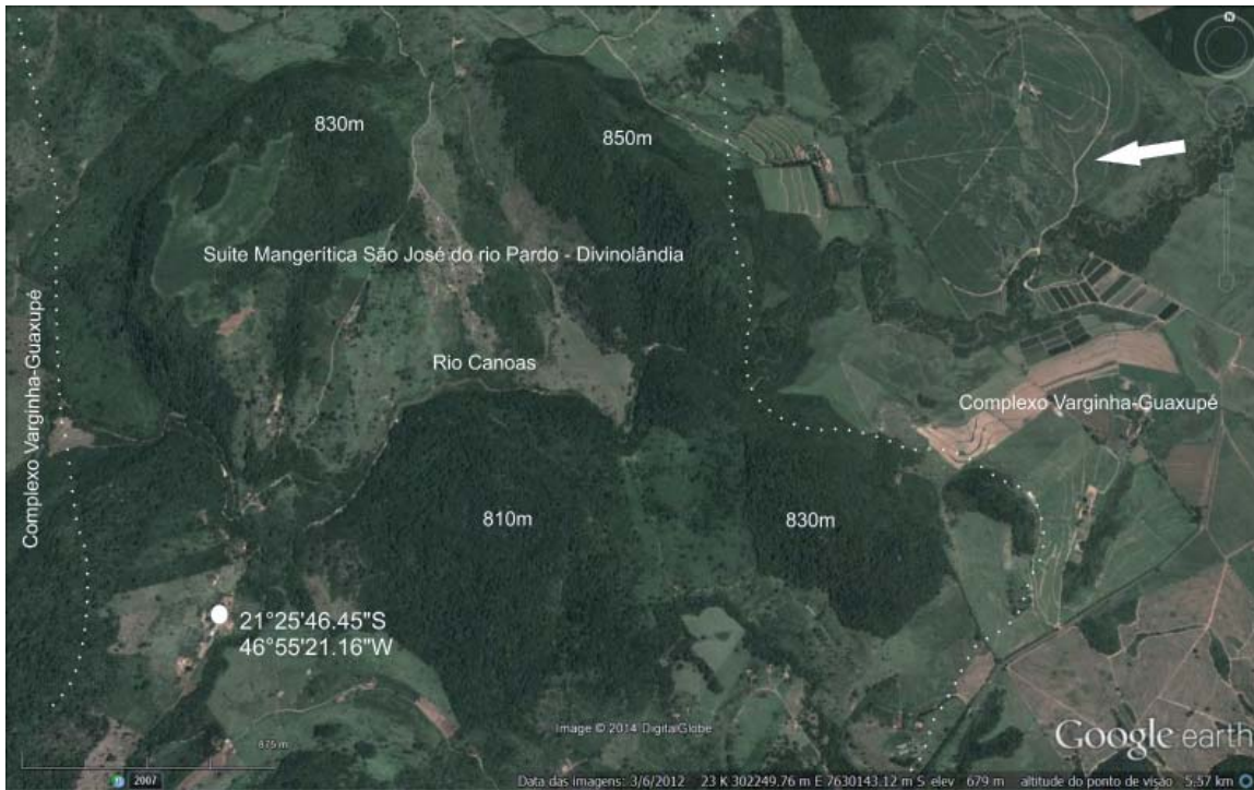
Figura 7 - Trecho do rio Canoas com controle estrutural. Ao lado direito da imagem o canal é meândrico, enquanto ao lado esquerdo o canal é retilíneo (a seta branca indica a direção do fluxo da drenagem e os números correspondem às cotas dos altos estruturais).
