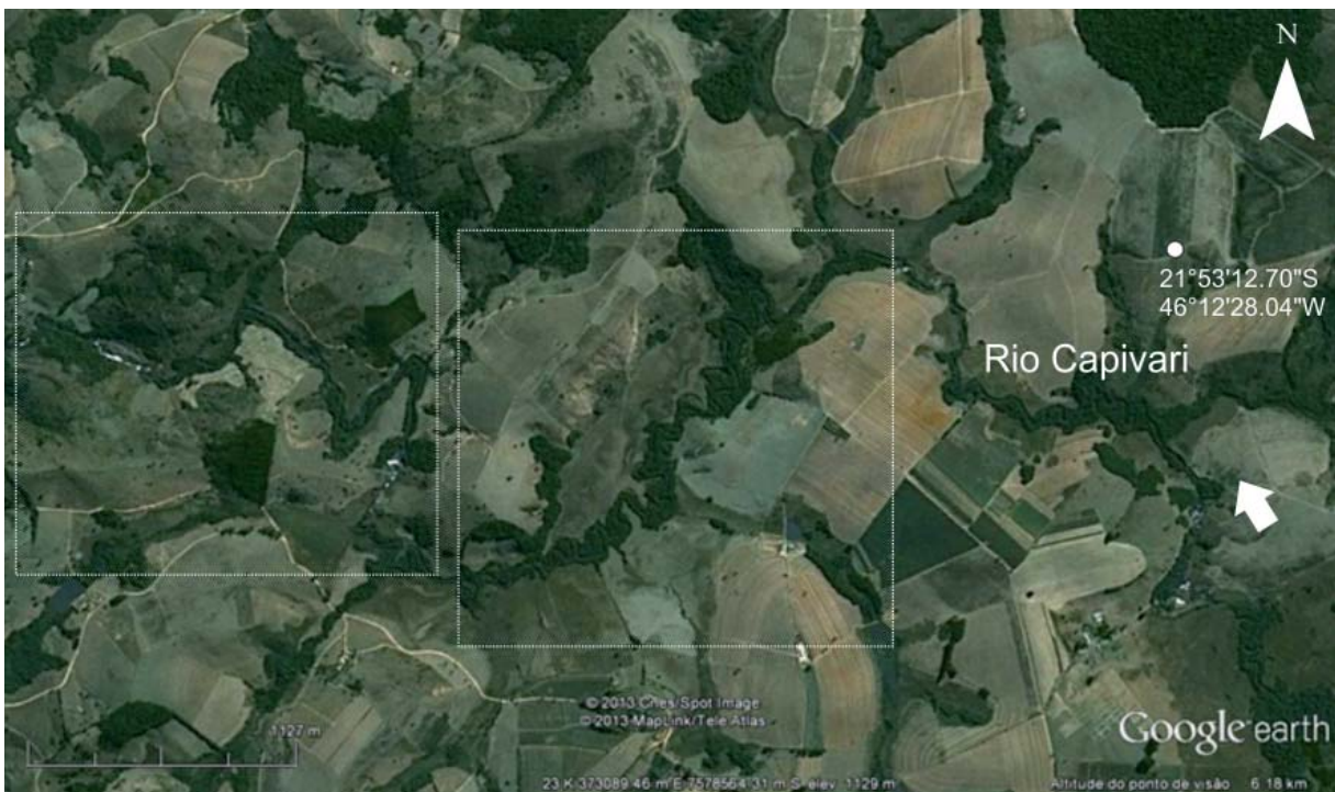
Figura 10 - Mudança brusca de padrão meandrante para retilíneo no rio Capivari (A seta branca indica a direção do fluxo da drenagem).
