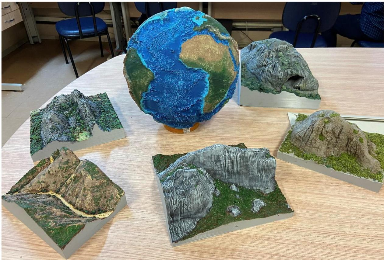
**Figura 3.** Maquetes impressas a partir de modelos digitais fotogramétricos. (A) Conjunto de maquetes geradas pelo Laboratório de Geomorfologia UFC.
