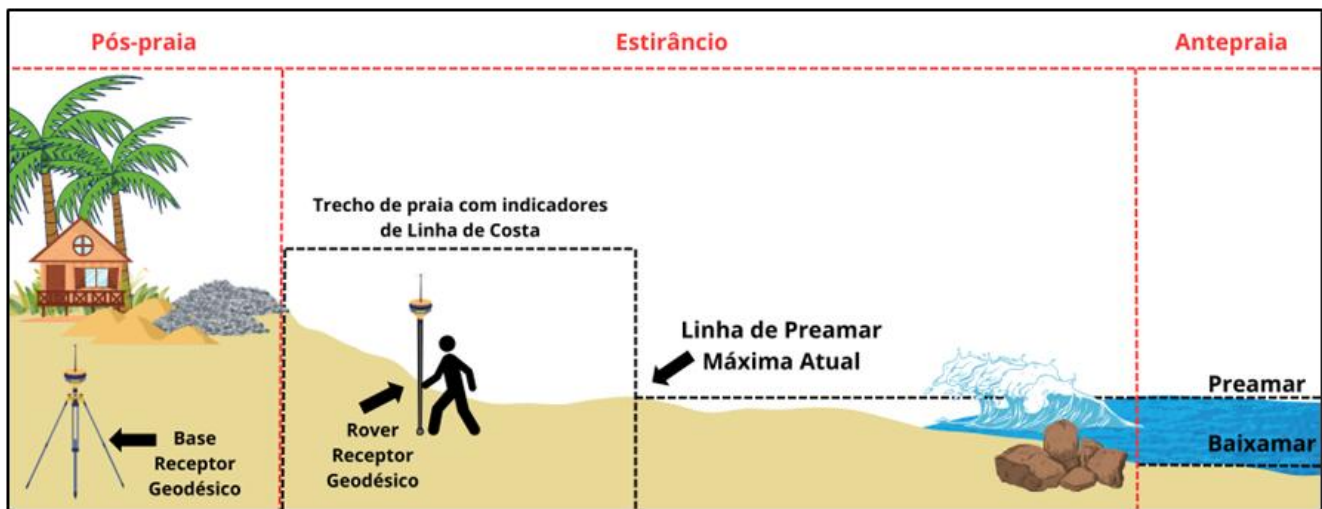
Figura 3. Etapa de campo do monitoramento da linha de costa em Icapuí por meio do uso de um receptor Geodésico.
