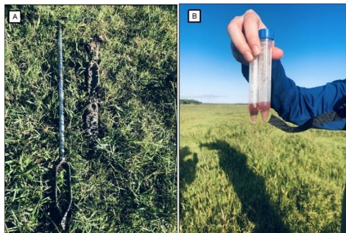
Figura 3. Aferição de solo hidromórfico: A) amostragem com trado; B) aplicação de a,a'-dipiridil, indicador pedoambiental de solos hidromórficos. Foto: dos autores.
