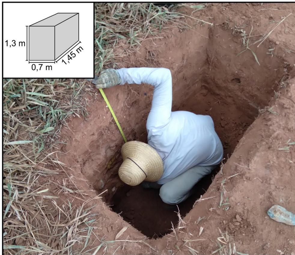
**Figura 2.** Trincheira escavada manualmente para a descrição dos materiais presentes no sopé da encosta.
