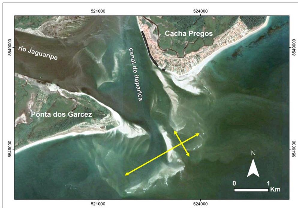
**Figura 3.** Morfologia assimétrica do delta de maré vazante, em frente à embocadura do canal de Itaparica, mostrando predomínio do transporte longitudinal de sedimentos para SW. Os vetores (setas em amarelo) indicam correntes *onshore-offshore* e transporte longitudinal.
