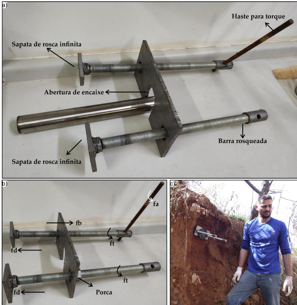
**Figura 3.** Alavanca para retirada dos tubos do depósito. a) Componentes da alavanca. b) fa: força aplicada pelo operador; ft: torque produzido na barra rosqueada; fd: força aplicada no depósito por sapatas; fb: força aplicada pelo sacador no amostrador. c) alavanca conectada na base de amostragem para retirada do tubo do pacote sedimentar.
