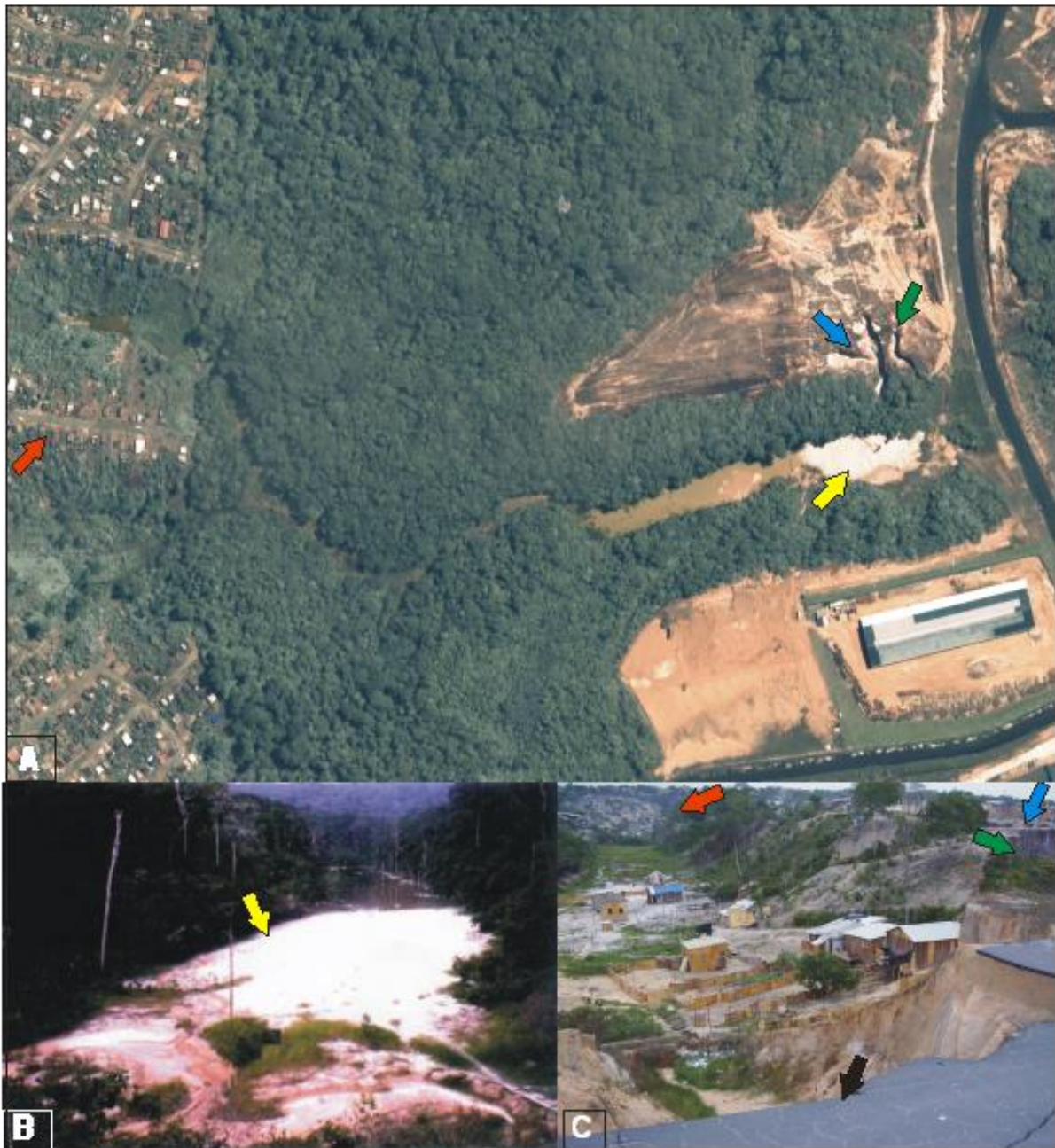
Figura 13. Localização e identificação de voçorocas através de imagens de satélite. A: recorte da imagem do Quickbird (2004); B: área de deposição de sedimentos oriundos das voçorocas 17 e 30; C: A mesma área B, mas agora com ocupação (Nova Vitória). As setas indicam: Vermelha - bairro Grande Vitória (fotos A e C); Amarela – área de deposição de sedimentos da voçoroca 17; Verde - voçoroca 17; Azul - voçoroca 30 (ambas incisões já existiam em 1999); Preta - voçoroca 36 (foto C) surgiu no final de 2005. Fonte: Vieira (2008).
