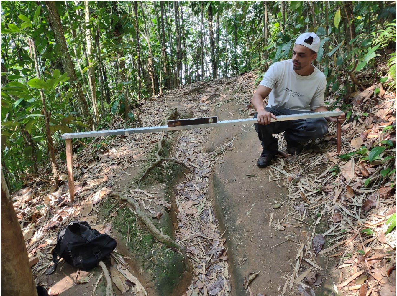
Figura 5. Ponte de erosão construída sobre o leito com feição erosiva monitorada na Trilha da Piscina Natural do Caixa D’Aço (Ponto 2). Foto: Autores (2021)
