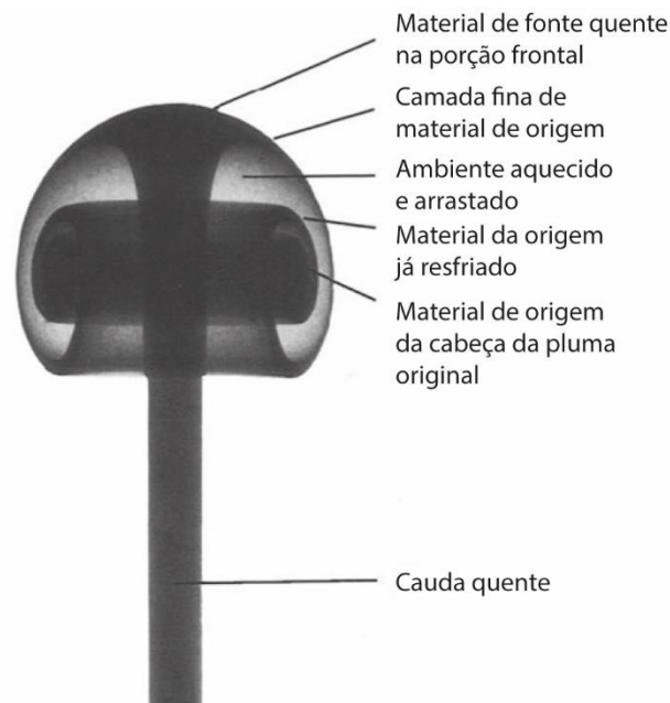
Figura 2. Modelo de pluma térmica gerada em experimento de laboratório mostrando a estrutura causada pela condução de calor e consequente arrastamento do fluido circundante. A área escura é o material quente da fonte da pluma e o material mais claro é o material arrastado e frio. Modificado de Campbell e Griffiths (1990).
