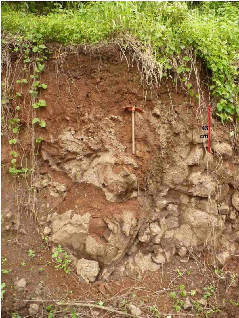
**Figura 4.** Rocha basáltica próxima à superfície, sob cobertura pedogenizada de caráter coluvial em posição de topo de morro a cerca de 400 metros de altitude.
