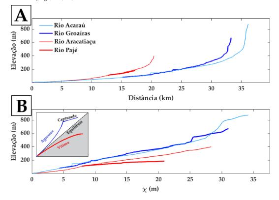
**Figura 5.** Perfis longitudinais (A) e perfis  $\chi$  (B) dos canais principais e dos rios Groaíras e Pajé. Em B, verifica-se as diferenças de poder erosivo e as condições de equilíbrio. Diagrama do perfil  $\chi$  (B) adaptado de Whipple et al. (2017) e Beeson; Mccoy; Keen-Zebert (2017).
