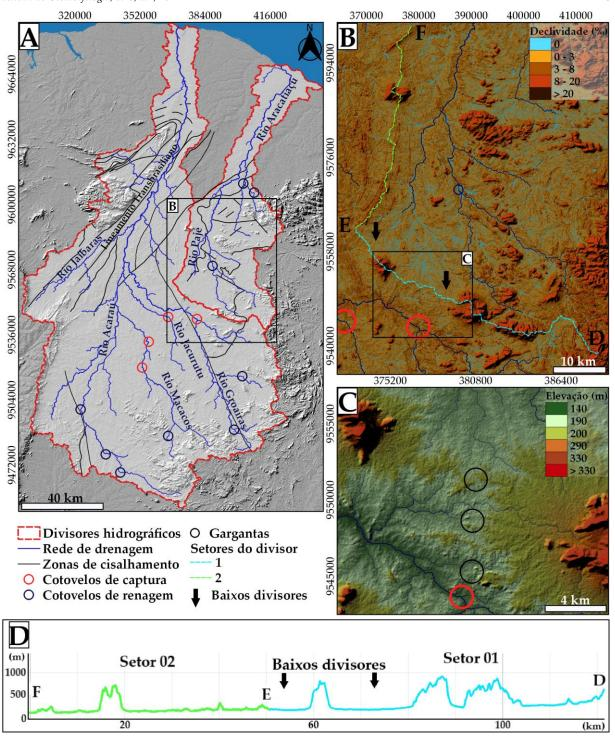
**Figura 3**. Evidências de captura fluvial entre as bacias hidrográficas do Acaraú e do Aracatiaçu. A - Rede de drenagem e cotovelos identificados em canais acima de 5ª ordem. B - Declividade (percentual) e setores do divisor hidrográfico. C - Hipsometria e drenagens em baixo divisor no Setor 01. D - Perfil topográfico do divisor com a localização dos baixos divisores.
