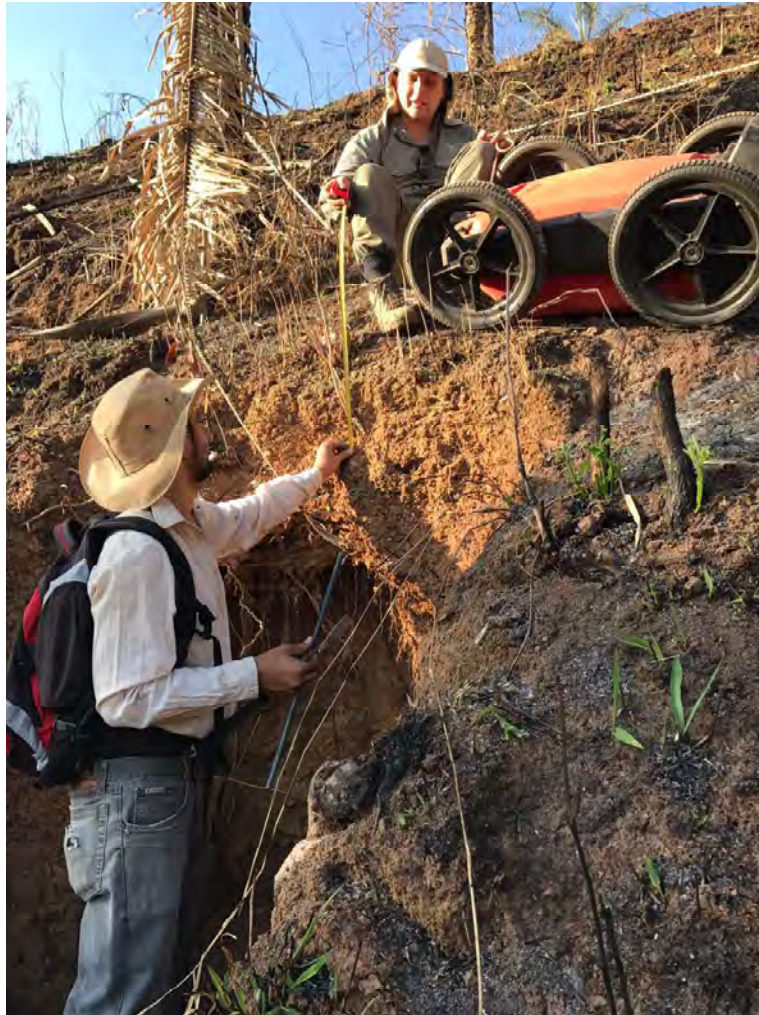
Figura 5 - Fotografia demonstrando o procedimento para o cálculo de velocidade.
