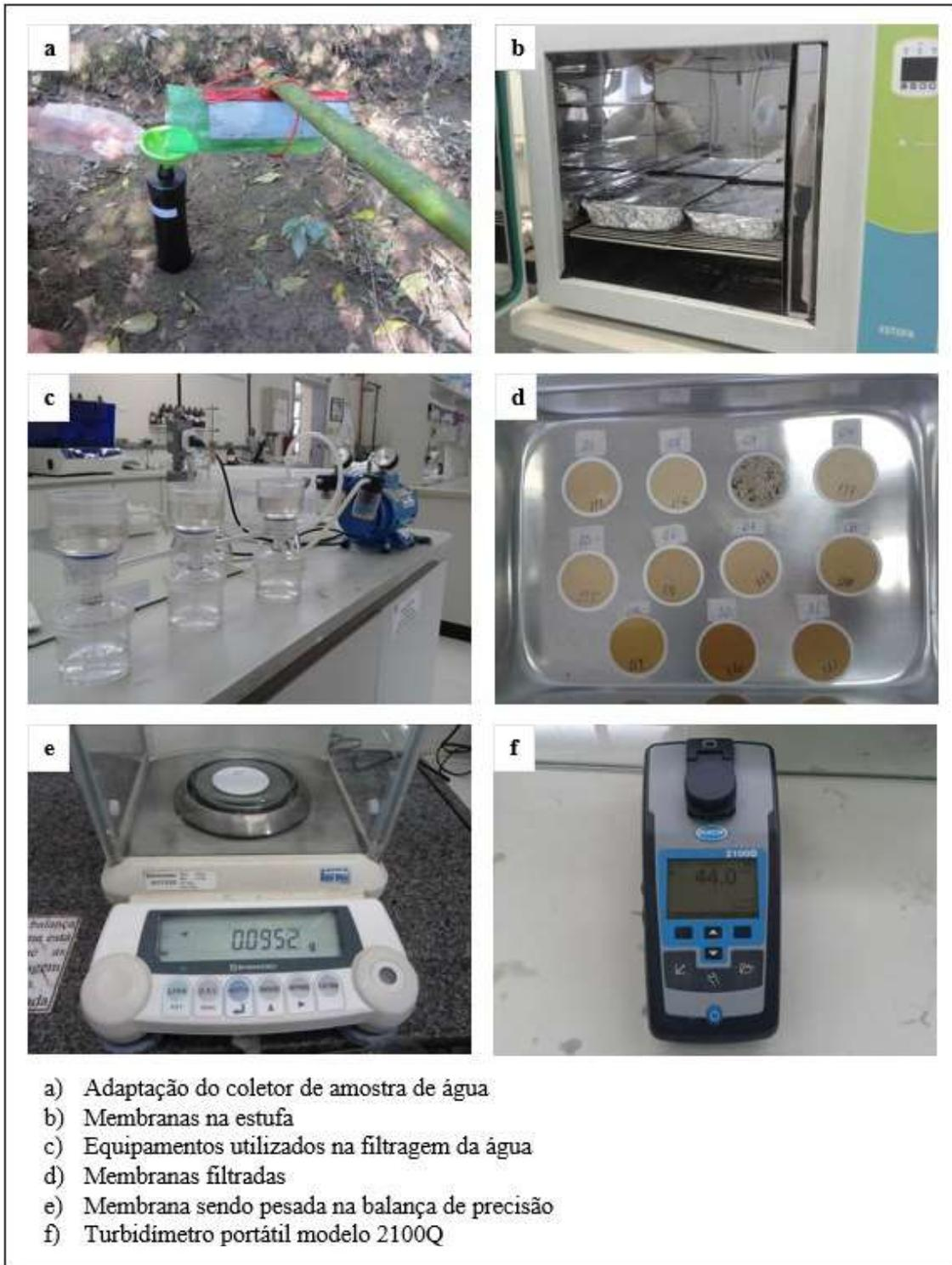
Figura 3 – Equipamentos utilizados para quantificação de sedimentos em suspensão. Fonte: Os autores (2018)
