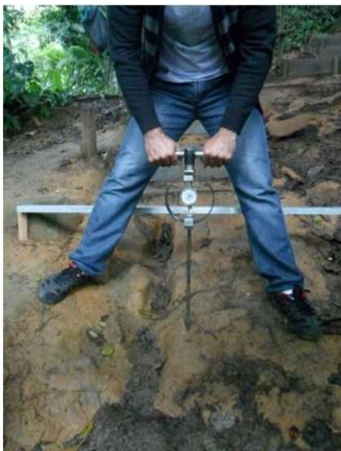
Figura 4 - Análise da capacidade de penetração no leito da trilha PNC através da utilização do penetrômetro. Foto: L. A. Rangel (2016).
