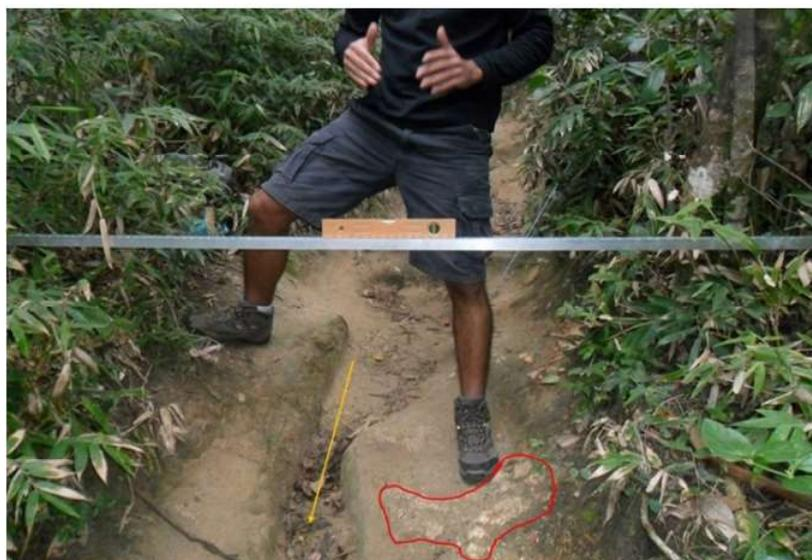
Figura 6 - Análise da microtopografia do solo, através da ponte de erosão, em PE 1 da trilha PMC em junho de 2016. A seta em amarelo indica ravina com acúmulo de serapilheira e o destaque em vermelho indica início de exposição do horizonte C. Foto: L. A. Rangel (2016).
