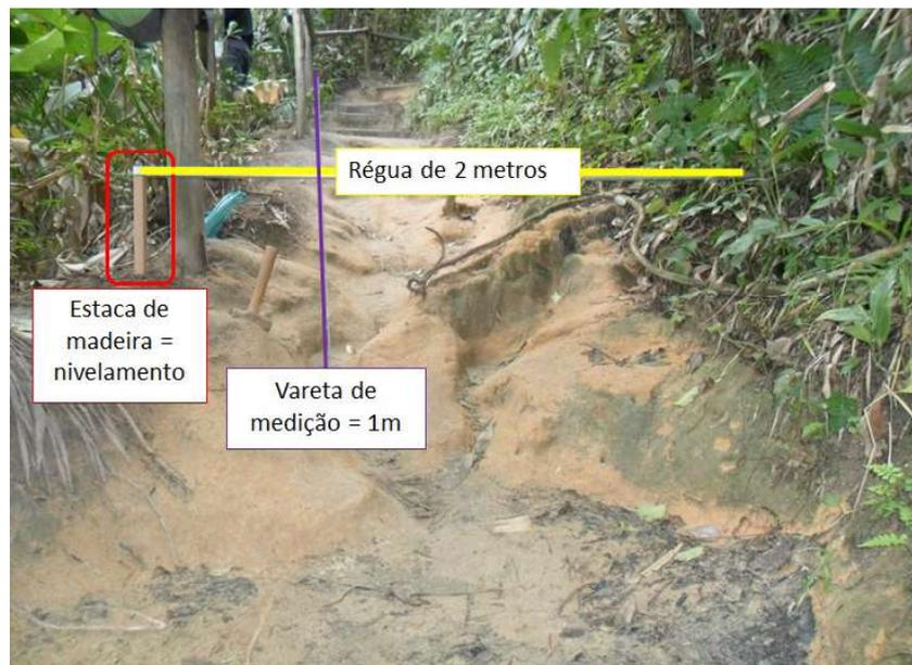
Figura 3 - Monitoramento a partir da ponte de erosão utilizada na trilha para a Praia Caixa D’Aço. Foto: L. A. Rangel (2016).
